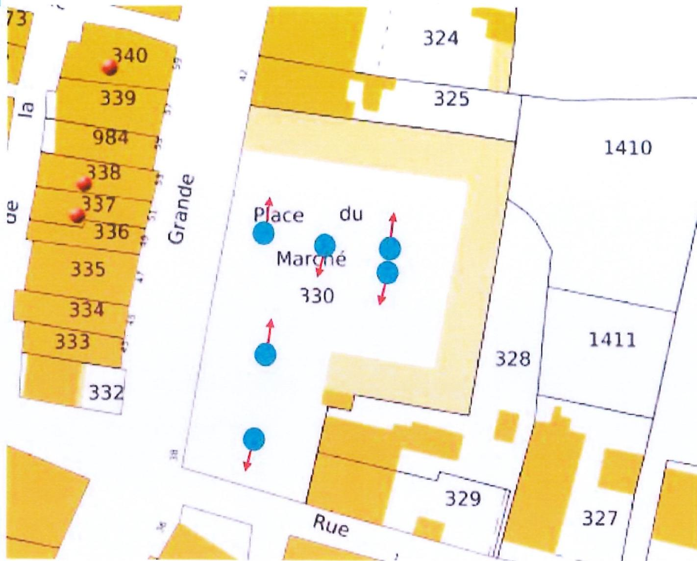
Dépose de 10 lanternes avec crosses et pose de 6 lanternes neuves
